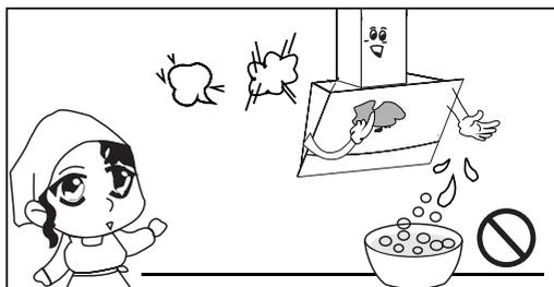
5) Алюмінієвий жиरोуловлюючий фільтр, утримуючи частки жиру і пилу, що проходять через нього, з повітря, засмічується. Його слід чистити засобами, які не включають кислоти, або мити після попереднього відмочування в гарячій воді за допомогою ефективного миючого засобу або, якщо це можливо, в посудомийній машині (при температурі 65°C).
