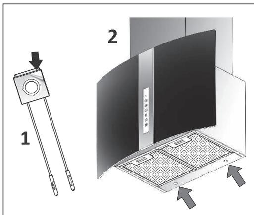
**УВАГА:** Вугільні фільтри встановлюються на обидва боки вентилятора
