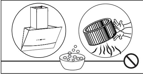
**7)** Чищення вентилятора мотору слід довірити відповідному спеціалісту або іншій кваліфікованій людині. Під час чищення вентилятора слід уникати його деформації.
