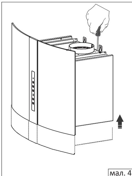
Вирівнявши витяжку, надійно закрутіть гвинти, вказані на малюнку 5. Після того, як витяжка буде встановлена, зафіксуйте корпус витяжки, прикрутивши два гвинти в отвори (C, D), так щоб витяжка не рухалася і була стійка.
