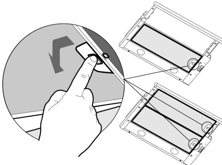
При знятті фільтра не натискайте із зусиллям на алюмінієву поверхню фільтра, так як це може привести до появи вм'ятин на його поверхні, що відобразиться на зовнішньому вигляді фільтра.
